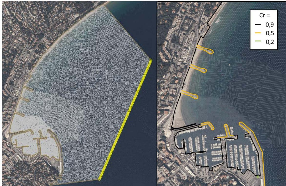
Figure 136 : Etendue du modèle d'agitation et maillage associé (gauche) – Caractéristiques des conditions appliquées sur le contour du modèle (droite)
